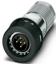
Steckverbinder, Universal, 5-polig, geschirmt, Stecker gerade M12 Push-Pull-Außenverriegelung, Kodierung: A, Crimpanschluss, Rändelmaterial: PA 6.6, Leitungsaußendurchmesser 4,5 mm ... 7,5 mm, ohne Crimpkontakte
