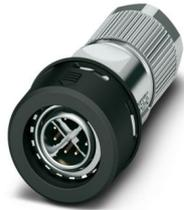
Datensteckverbinder, Ethernet CAT6<sub>A</sub> (10 GBit/s), PROFINET CAT6<sub>A</sub> (10 GBit/s), 8-polig, geschirmt, Stecker gerade M12 Push-Pull-Außenverriegelung, Kodierung: X, Crimpanschluss, Rändelmaterial: PA 6.6, Leitungsaußendurchmesser 6,5 mm ... 10 mm, ohne Crimpkontakte
