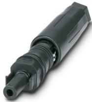
Steckverbinder, Artikelfamilie: SUNCLIX, Farbe: schwarz, Polzahl: 1, Aderquerschnitt min.: 2,5 mm<sup>2</sup>, Aderquerschnitt max.: 6 mm<sup>2</sup>, Bemessungsspannung: 1500 V DC, Bemessungsstrom: 35 A, Anschlussart: Federkraft, Kabeldurchmesser min.: 5 mm, Kabeldurchmesser max.: 8 mm
