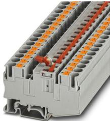
Messertrennklemme, Nennspannung: 500 V, Nennstrom: 20 A, Anschlussart: Push-in-Anschluss, Bemessungsquerschnitt: 6 mm<sup>2</sup>, Querschnitt: 0,5 mm<sup>2</sup> - 10 mm<sup>2</sup>, Montage: NS 35/7,5, NS 35/15, NS 32, Farbe: grau
