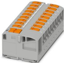
Verteilerblock, Nennspannung: 450 V, Nennstrom: 24 A, Anzahl der Anschlüsse: 19, Polzahl: 1, Anschlussart: Push-in-Anschluss, Bemessungsquerschnitt: 2,5 mm<sup>2</sup>, Abgriff, Querschnitt: 0,14 mm<sup>2</sup> - 4 mm<sup>2</sup>, Sammelschluss, Bemessungsquerschnitt: 6 mm<sup>2</sup>, Querschnitt: 0,5 mm<sup>2</sup> - 10 mm<sup>2</sup>, Montageart: aufrasten auf Tragschienenadapter, Direktmontage mit Flansch, Fliegend, Farbe: grau
