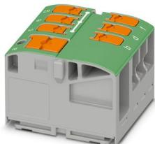
Verteilerblock, Nennspannung: 450 V, Nennstrom: 24 A, Anzahl der Anschlüsse: 7, Polzahl: 1, Anschlussart: Push-in-Anschluss, Bemessungsquerschnitt: 2,5 mm<sup>2</sup>, Abgriff, Querschnitt: 0,14 mm<sup>2</sup> - 4 mm<sup>2</sup>, Sammelanschluss, Bemessungsquerschnitt: 6 mm<sup>2</sup>, Querschnitt: 0,5 mm<sup>2</sup> - 10 mm<sup>2</sup>, Montageart: aufrasten auf Tragschienenadapter, Direktmontage mit Flansch, Fliegend, Farbe: grün
