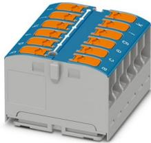
Verteilerblock, Nennspannung: 450 V, Nennstrom: 24 A, Anzahl der Anschlüsse: 12, Polzahl: 1, Anschlussart: Push-in-Anschluss, Bemessungsquerschnitt: 2,5 mm<sup>2</sup>, Querschnitt: 0,14 mm<sup>2</sup> - 4 mm<sup>2</sup>, Montageart: aufrasten auf Tragschienenadapter, Direktmontage mit Flansch, Fliegend, Farbe: blau
