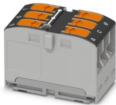
Verteilerblock, Nennspannung: 450 V, Nennstrom: 24 A, Anzahl der Anschlüsse: 6, Polzahl: 1, Anschlussart: Push-in-Anschluss, Bemessungsquerschnitt: 2,5 mm<sup>2</sup>, Querschnitt: 0,14 mm<sup>2</sup> - 4 mm<sup>2</sup>, Montageart: aufrasten auf Tragschienenadapter, Direktmontage mit Flansch, Fliegend, Farbe: schwarz
