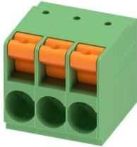
Leiterplattenklemme, Nennstrom: 76 A, Bemessungsspannung (III/2): 1000 V, Nennquerschnitt: 16 mm<sup>2</sup>, Anzahl der Potenziale: 3, Anzahl der Reihen: 1, Polzahl pro Reihe: 3, Artikelfamilie: TDPT 16/...-SP, Rastermaß: 10,16 mm, Anschlussart: Push-in-Federanschluss, Montage: Wellenlöten, Anschlussrichtung Leiter/Platine: 0 °, Farbe: grün, Pin-Layout: Zick-Zack-Pinning W, Pinlänge [P]: 3,5 mm, Anzahl der Lötpins pro Potenzial: 2, Verpackungsart: verpackt im Karton
