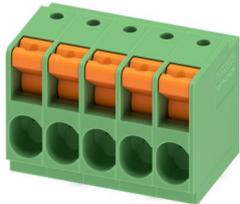
Leiterplattenklemme, Nennstrom: 41 A, Bemessungsspannung (III/2): 1000 V, Nennquerschnitt: 4 mm<sup>2</sup>, Anzahl der Potenziale: 5, Anzahl der Reihen: 1, Polzahl pro Reihe: 5, Artikelfamilie: TDPT 4/...-SP, Rastermaß: 6,35 mm, Anschlussart: Push-in-Federanschluss, Montage: Wellenlöten, Anschlussrichtung Leiter/Platine: 0 °, Farbe: grün, Pin-Layout: Zick-Zack-Pinning W, Pinlänge [P]: 3,5 mm, Anzahl der Lötpins pro Potenzial: 1, Verpackungsart: verpackt im Karton
