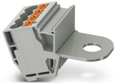
Abgriffklemme, Nennspannung: 1000 V, Nennstrom: 41 A, Anzahl der Anschlüsse: 5, Anschlussart: Push-in-Anschluss, Bemessungsquerschnitt: 6 mm<sup>2</sup>, 1. Etage, Querschnitt: 0,5 mm<sup>2</sup> - 10 mm<sup>2</sup>, Bolzenanschluss, Sammelschluss, Montageart: auf Basiselement, Farbe: grau
