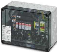
Generatoranschlusskasten für Photovoltaikanlagen bis 1000 V DC zum Anschluss von 2x 2 Strings. Mit Überspannungsschutz (Typ 1/2) und SUNCLIX-DC-Steckverbindern für die Eingangs- und Ausgangsseite (SUNCLIX-Gegenstecker im Lieferumfang).
