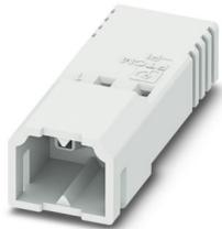
Leiterplattenstecker, Nennquerschnitt: 0,75 mm<sup>2</sup>, Farbe: weiß, Nennstrom: 6 A, Bemessungsspannung (III/2): 160 V, Kontaktart: Stift, Anzahl der Potenziale: 2, Anzahl der Reihen: 1, Polzahl: 2, Anzahl der Anschlüsse: 2, Artikelfamilie: PTCM 0,5/..-PI, Rastermaß: 2,5 mm, Anschlussart: Crimpanschluss, Anschlussrichtung Leiter/Platine: 0 °, Stecksystem: COMBICON PTSM, Verriegelung: Rastverriegelung, Befestigungsart: Rastnase, Verpackungsart: verpackt im Karton
