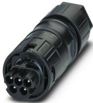
Steckverbinder, Artikelfamilie: PRC 35, Bauform: Entriegelung mit Werkzeug oder von Hand (siehe Zubehör), Farbe: schwarz, Polzahl: 5, Aderquerschnitt min.: 1,5 mm<sup>2</sup>, Aderquerschnitt max.: 6 mm<sup>2</sup>, Bemessungsspannung: 690 V AC, Bemessungsstrom: 35 A, Anschlussart: Schraubanschluss, Kabeldurchmesser min.: 8 mm, Kabeldurchmesser max.: 21 mm, Gewährleistet Fingerberührschutz
