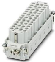
Kontakteinsatz, Polzahl: 46+PE, Baugröße: B24, Leistungskontakte: 46, Steuerkontakte: 0, Anzahl der Anschlüsse je Pol: 1, Buchse, Push-in-Anschluss, 500 V, 16 A, 0,5 mm<sup>2</sup> ... 2,5 mm<sup>2</sup>, Anwendung: Leistung
