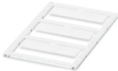
Einrastschildchen, Matte, weiß, unbeschriftet, beschriftbar mit: BLUEMARK E.CARD, BLUEMARK ID COLOR, BLUEMARK ID, BLUEMARK CLED, THERMOMARK PRIME, THERMOMARK CARD 2.0, THERMOMARK CARD, TOPMARK NEO, TOPMARK LASER, Montageart: einlegen, Anzahl der Einzelschilder: 3, Textfeldhöhe: 15 mm, Textfeldbreite: 60 mm
