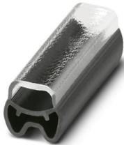
Ader-Bezeichnungsträger, transparent/schwarz, unbeschriftet, Kabeldurchmesserbereich: 1,3 ... 2,8 mm, Montageart: aufschieben, Textfeldhöhe: 4 mm, Textfeldbreite: 15 mm
