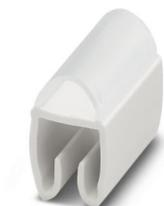
Ader-Bezeichnungsträger, transparent, unbeschriftet, Kabeldurchmesserbereich: 2,8 ... 4,4 mm, Montageart: aufclipsen, Textfeldhöhe: 4 mm, Textfeldbreite: 10 mm
