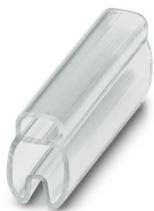
Ader-Bezeichnungsträger, transparent, unbeschriftet, Kabeldurchmesserbereich: 4 ... 7 mm, Montageart: aufschieben, Textfeldhöhe: 4 mm, Textfeldbreite: 23 mm
