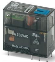
Steckbares Miniaturrelais, mit Mehrlagenkontakt mit Hartgoldauflage, 2 Wechsler, Prüftaste, mechanische Schaltstellungsanzeige, Status-LED, Freilaufdiode, Polarität A1+, A2-, Eingangsspannung 110 V DC
