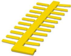
Einsteckschild, Streifen, gelb, unbeschriftet, beschriftbar mit: CMS-P1-PLOTTER, Kabeldurchmesserbereich: 0,6 ... 50 mm, Montageart: aufschieben, Anzahl der Einzelschilder: 20, Textfeldhöhe: 4 mm, Textfeldbreite: 15 mm
