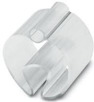
Ader-Bezeichnungsträger, transparent, unbeschriftet, Kabeldurchmesserbereich: 14 ... 22 mm, Montageart: aufschieben, Textfeldhöhe: 4 mm, Textfeldbreite: 15 mm
