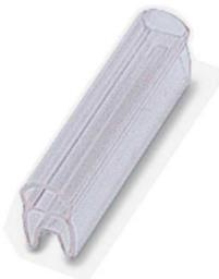
Ader-Bezeichnungsträger, transparent, unbeschriftet, Kabeldurchmesserbereich: 2 ... 4 mm, Montageart: aufschieben, Textfeldhöhe: 4 mm, Textfeldbreite: 15 mm
