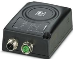
Kombiniertes Ethernet-Funkmodul mit Bluetooth und WLAN, interne Antenne, WLAN: AP und Client, 2.4 und 5 GHz, Bluetooth: 2.1+EDR/4.0, PAN bis 7 Verbindungen, IP65, 9 ... 30 V DC, M12-Anschluss, WEB, AT-Kommandos und Mode-Button
