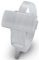
Kunststoff-Kabelmarker, transparent, unbeschriftet, Kabeldurchmesserbereich: 16 ... 35 mm, Montageart: Kabelbindermontage, Textfeldhöhe: 17 mm, Textfeldbreite: 40 mm
