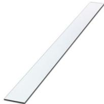
Flachbandabdeckung, zum Abdecken von Klemmenleisten, 2 mm dick, 7 cm breit, zusätzlich erforderlich sind 2 Endhalter E/UK und 2 verstellbare Abdeckungshalter VAH. Die max. Lieferlänge beträgt 100 cm
