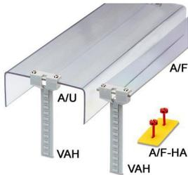
Flachbandabdeckung, zum Abdecken von Klemmenleisten, 2 mm dick, 17,5 cm breit, zusätzlich erforderlich sind 2 Endhalter E/UK und 2 verstellbare Abdeckungshalter VAH. Die max. Lieferlänge beträgt 100 cm
