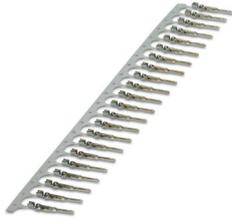
Crimpkontakt, Stift, gerollt, Kontaktdurchmesser: 1,6 mm, Anschlussquerschnitt: 0,34 mm<sup>2</sup> ... 1 mm<sup>2</sup>, AWG 22...17, Material Kontakt: Cu-Legierung
