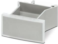
Schildchenträger, für die Kennzeichnung von Klemmengruppen, zur Montage auf die Klemmenleiste NS 32 oder NS 35/7,5, grau, unbeschriftet, Montageart: verrasten, Textfeldhöhe: 17 mm, Textfeldbreite: 40 mm
