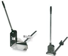
Set, bestehend aus Verdrahtungskanalschneider PPS CD M, zum gratfreien Schneiden von Verdrahtungskanälen und deren Deckel, einsetzbar bis zu einer Breite von 125 mm. Schienenschneider PPS BASIC I/M, zum Ablängen von Normtragschienen, NS 15 / NS 35/7,5 / NS 35/15 sowie zum Ablängen der Neutralleiter-Sammelschiene NLS-CU 3/10, mit Maßschiene Inch/Metrisch
