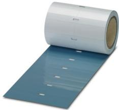
Einsteckschild, zur Kennzeichnung von Siemens Steuerungen ET 200SP HA, Rolle, grau, unbeschriftet, beschriftbar mit: THERMOMARK E.300 (D)/600 (D), THERMOMARK ROLL 2.0, THERMOMARK ROLL, THERMOMARK ROLL X1, THERMOMARK ROLLMASTER 300/600, THERMOMARK X1.2, Montageart: einschieben, Anzahl der Einzelschilder: 500, Textfeldhöhe: 18,8 mm, Textfeldbreite: 50 mm
