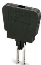
Sicherungsstecker, Nennspannung: 250 V, Nennstrom: 6,3 A, Anschlussart: Steckanschluss, Tiefe: 45,7 mm, Breite: 6,1 mm, Höhe: 33,1 mm, Farbe: schwarz
