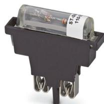
Sicherungsstecker, Nennspannung: 400 V, Nennstrom: 6,3 A, Anschlussart: Steckanschluss, Breite: 9,9 mm, Höhe: 45,4 mm, Farbe: schwarz
