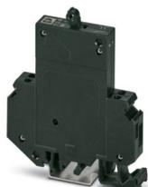
Thermomagnetischer Schutzschalter, 1-polig, mittelträge, 1 Öffner, mit Universalfuß zur Montage auf NS 32 oder NS 35
