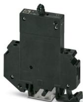
Thermomagnetischer Geräteschutzschalter, 1-polig, Anschlussart: Schraubanschluss, Nennstrom: 1 A, Auslösekennlinie: F1 (flink), Art der Sicherung: Automat, Montageart: Tragschiene: 35 mm, Bemessungsstrom: 1 A
