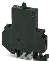
Thermomagnetischer Geräteschutzschalter, 1-polig, Anschlussart: Schraubanschluss, Nennstrom: 0,6 A, Auslösekennlinie: F1 (flink), Art der Sicherung: Automat, Montageart: Tragschiene: 35 mm, Bemessungsstrom: 0,6 A
