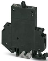
Thermomagnetischer Geräteschutzschalter, 1-polig, Anschlussart: Schraubanschluss, Auslösekennlinie: F1 (flick), Art der Sicherung: Automat, Montageart: Tragschiene: 35 mm, Bemessungsstrom: 0,2 A
