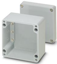
Leergehäuse, Material: Polyester glasfaserverstärkt, fehgrau RAL 7000, 160 mm x 560 mm x 91 mm, Verschlussart: geschraubter Deckel
