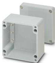
Leergehäuse, Material: Polyester glasfaserverstärkt, fehgrau RAL 7000, 75 mm x 160 mm x 75 mm, Verschlussart: geschraubter Deckel
