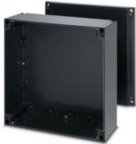
Leergehäuse, mit zwei Verdrahtungsebenen, Material: Polyester glasfaserverstärkt, mit Graphitzusatz, schwarz, 360 mm x 360 mm x 145 mm, Verschlussart: geschraubter Deckel
