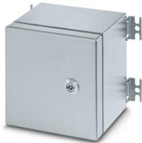
Leergehäuse, Material: Edelstahl 316L / 1.4404, Oberflächenwiderstand: gebürstet, silberfarben, 382 mm x 458 mm x 160 mm, Verschlussart: Tür mit wechselbarem Scharnier, Lieferumfang - ATD: Türscharnier mit Vierteldrehverschluss, Montageplatte, Doppelbartschlüssel, Befestigungswinkel mit Montageschrauben, Erdungsbolzen M12 außenseitig angebracht, Installationsanweisung, Türscharnier mit Vierteldrehverschluss
