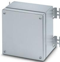
Leergehäuse, Material: Edelstahl 316L / 1.4404, Oberflächenwiderstand: gebürstet, silberfarben, 300 mm x 200 mm x 120 mm, Verschlussart: geschraubter Deckel, Lieferumfang - ATD: Montageplatte, Befestigungswinkel mit Montageschrauben, Erdungsbolzen M12 außenseitig angebracht, Installationsanweisung, Montageplatte
