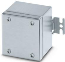
Leergehäuse, Material: Edelstahl 316L / 1.4404, Oberflächenwiderstand: gebürstet, silberfarben, 100 mm x 100 mm x 80 mm, Verschlussart: geschraubter Deckel, Lieferumfang - ATD: Befestigungswinkel mit Montageschrauben, Erdungsbolzen M12 außenseitig angebracht, Installationsanweisung, Befestigungswinkel mit Montageschrauben
