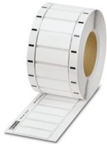
Schrumpfschlauch, Rolle, weiß, unbeschriftet, beschriftbar mit: THERMOMARK E.300 (D)/600 (D), THERMOMARK ROLLMASTER 300/600, THERMOMARK ROLL X1, THERMOMARK ROLL, THERMOMARK ROLL 2.0, THERMOMARK X1.2, Kabeldurchmesserbereich: 6,4 ... 12,7 mm, unperforiert, Montageart: aufschieben, Anzahl der Einzelschilder: 500, Textfeldhöhe: 20 mm, Textfeldbreite: 60 mm
