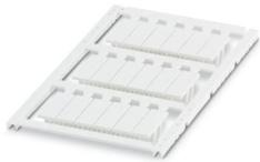
Leitermarkierung, Matte, weiß, unbeschriftet, beschriftbar mit: BLUEMARK E.CARD, BLUEMARK ID COLOR, BLUEMARK ID, BLUEMARK CLED, THERMOMARK PRIME 2.0, THERMOMARK PRIME, THERMOMARK CARD 2.0, THERMOMARK CARD, TOPMARK NEO, TOPMARK LASER, Kabeldurchmesserbereich: 5,4 ... 6,1 mm, Montageart: aufclipsen, Anzahl der Einzelschilder: 18, Textfeldhöhe: 8 mm, Textfeldbreite: 23 mm
