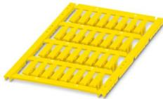
Leitermarkierung, Matte, gelb, unbeschriftet, beschriftbar mit: BLUEMARK E.CARD, BLUEMARK ID COLOR, BLUEMARK ID, BLUEMARK CLED, THERMOMARK PRIME 2.0, THERMOMARK PRIME, THERMOMARK CARD 2.0, THERMOMARK CARD, TOPMARK NEO, TOPMARK LASER, Kabeldurchmesserbereich: 3,5 ... 4,1 mm, Montageart: aufclipsen, Anzahl der Einzelschilder: 32, Textfeldhöhe: 4 mm, Textfeldbreite: 18 mm
