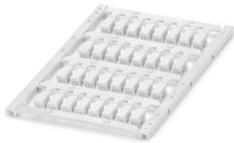
Leitermarkierung, Matte, weiß, unbeschriftet, beschriftbar mit: BLUEMARK E.CARD, BLUEMARK ID COLOR, BLUEMARK ID, BLUEMARK CLED, THERMOMARK PRIME 2.0, THERMOMARK PRIME, THERMOMARK CARD 2.0, THERMOMARK CARD, TOPMARK NEO, TOPMARK LASER, Kabeldurchmesserbereich: 2 ... 2,9 mm, Montageart: aufclipsen, Anzahl der Einzelschilder: 32, Textfeldhöhe: 4 mm, Textfeldbreite: 12 mm
