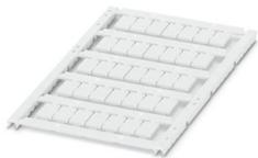
Marker für Klemmen, zur Beschriftung von ABB-Klemmen der SNK-Baureihe, Matte, weiß, unbeschriftet, beschriftbar mit: BLUEMARK E.CARD, BLUEMARK ID COLOR, BLUEMARK ID, THERMOMARK PRIME 2.0, THERMOMARK PRIME, THERMOMARK CARD 2.0, THERMOMARK CARD, TOPMARK NEO, TOPMARK LASER, Montageart: verrasten, für Klemmenbreite: 8 mm, Anzahl der Einzelschilder: 35, Textfeldhöhe: 11,3 mm, Textfeldbreite: 6,85 mm
