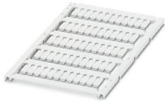
Marker für Klemmen, zur Beschriftung von Entrelec-Klemmen, Matte, weiß, unbeschriftet, beschriftbar mit: BLUEMARK E.CARD, BLUEMARK ID COLOR, BLUEMARK ID, THERMOMARK PRIME 2.0, THERMOMARK PRIME, THERMOMARK CARD 2.0, THERMOMARK CARD, TOPMARK NEO, TOPMARK LASER, Montageart: verrasten, für Klemmenbreite: 5 mm, Anzahl der Einzelschilder: 60, Textfeldhöhe: 9,3 mm, Textfeldbreite: 3,85 mm
