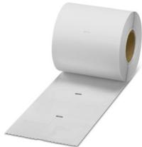
Kabelwickeletikett, Rolle, weiß, unbeschriftet, beschriftbar mit: THERMOMARK E.300 (D)/600 (D), THERMOMARK ROLL 2.0, THERMOMARK ROLL, THERMOMARK ROLL X1, THERMOMARK ROLLMASTER 300/600, THERMOMARK X1.2, Kabeldurchmesserbereich: 6,1 ... 14,2 mm, Montageart: kleben, Kabeldurchmesser:  $\leq$  14,2 mm, Anzahl der Einzelschilder: 3000, Textfeldhöhe: 19,1 mm, Textfeldbreite: 38,1 mm
